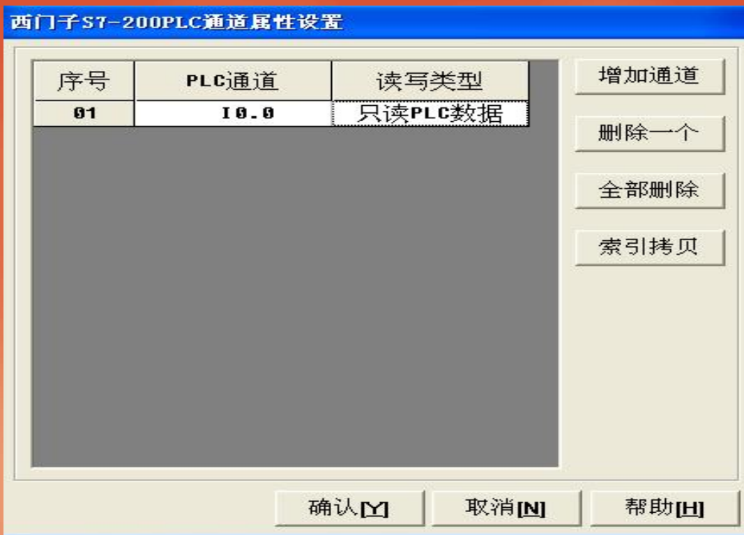
图11 PLC通道属性设备对话框
