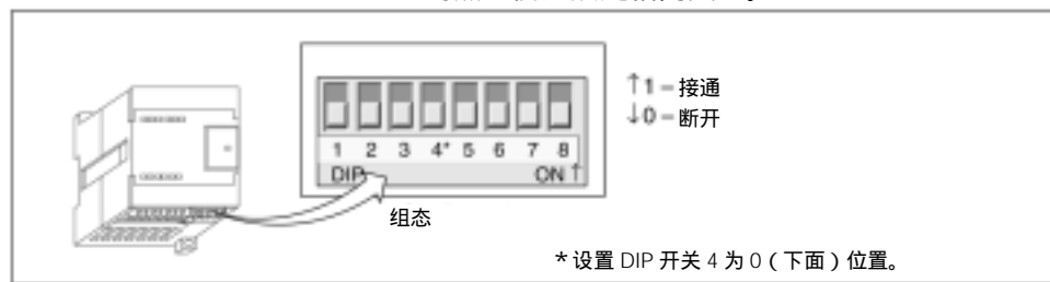
图 31 组态 EM231 热电偶模块的 DIP 开关
